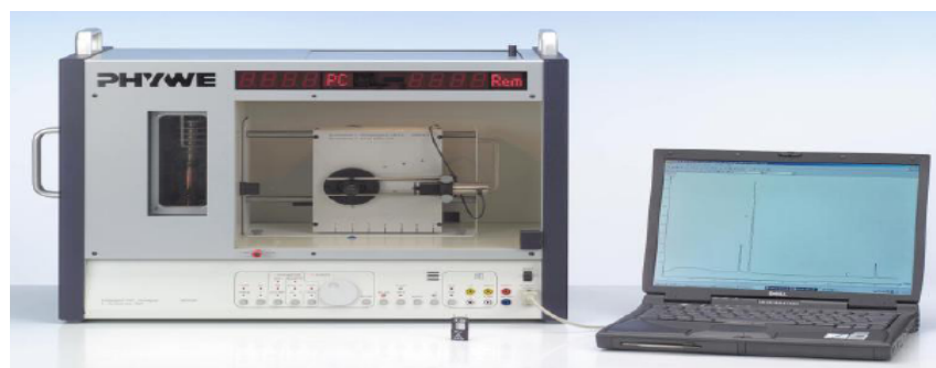
Rys. 27. Dyfraktometr rentgenowski PHYWE .
