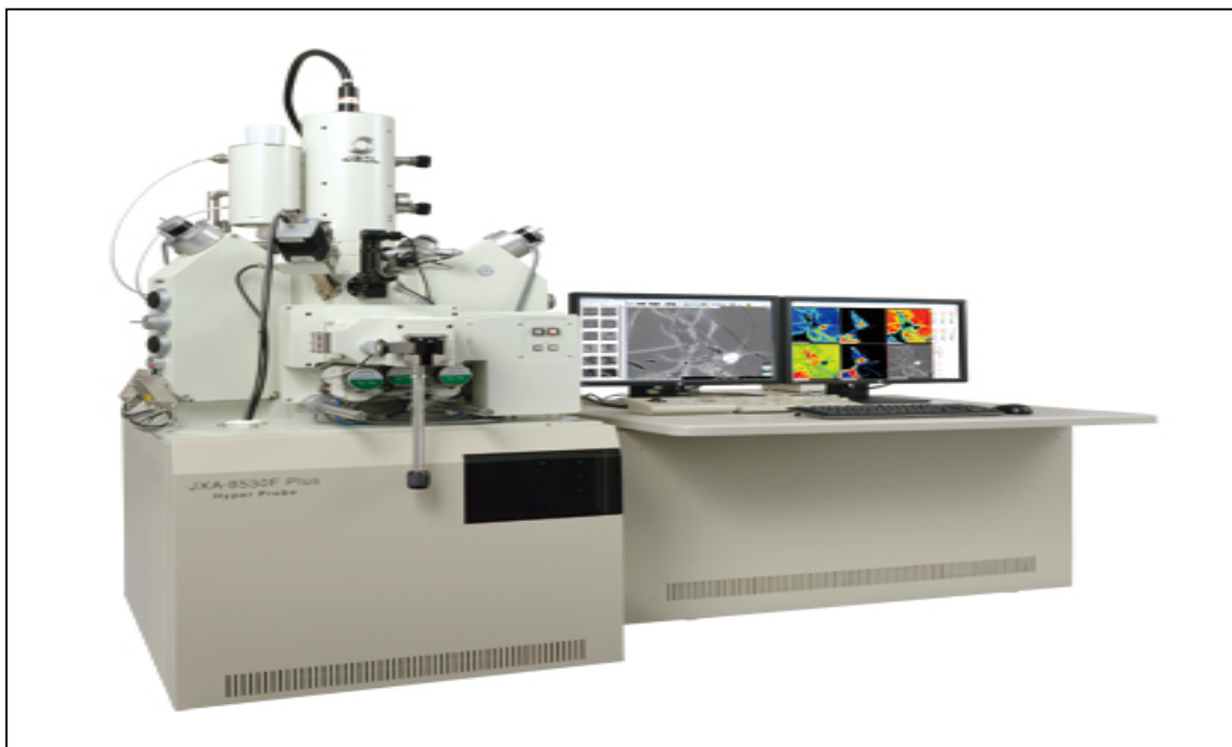
Rys. 38. Mikroanalizator rentgenowski produkcji japońskiej JXA-8530FPlus
